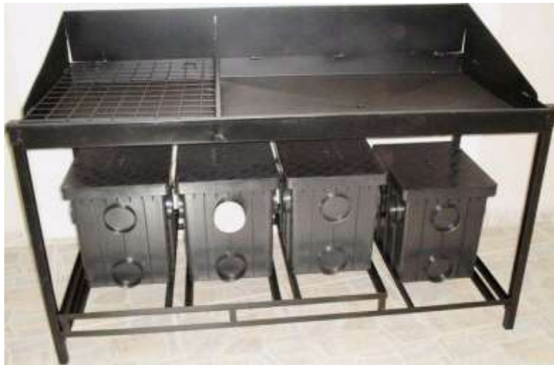
Figura 7. Bancada de lavagem de peças com caixas de separação de água e óleo. Fonte: dados da pesquisa.
