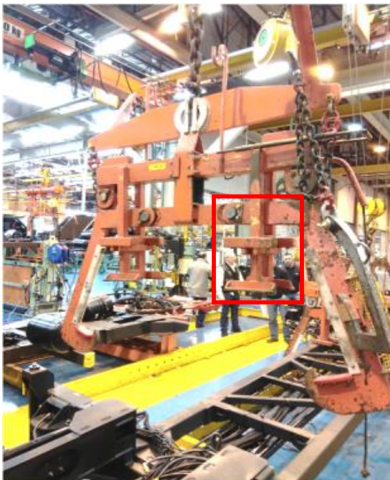
Figura 07 – Ganchos para transferência para a linha de montagem de rodas
