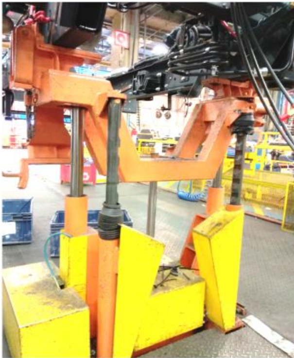
Figura 06– Estação de montagem de suportes metálicos, válvulas, reservatórios de ar dentre outros
