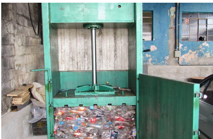
Figura 3: Imagem de prensa utilizada pela ASMARE para a compactação dos resíduos. Fonte: ASMARE (2019)
