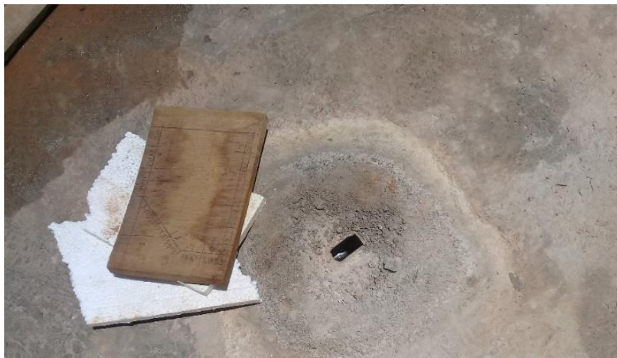
Figura 4 – Isolamento feito com folhas de isopor na região da coleta de temperatura do núcleo
