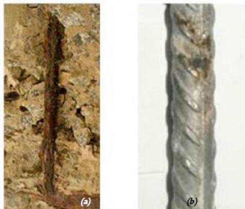
**Figura 2 – Corrosão generalizada irregular (a) e corrosão por pites (b). Fonte: (MEIRA, 2017)**
