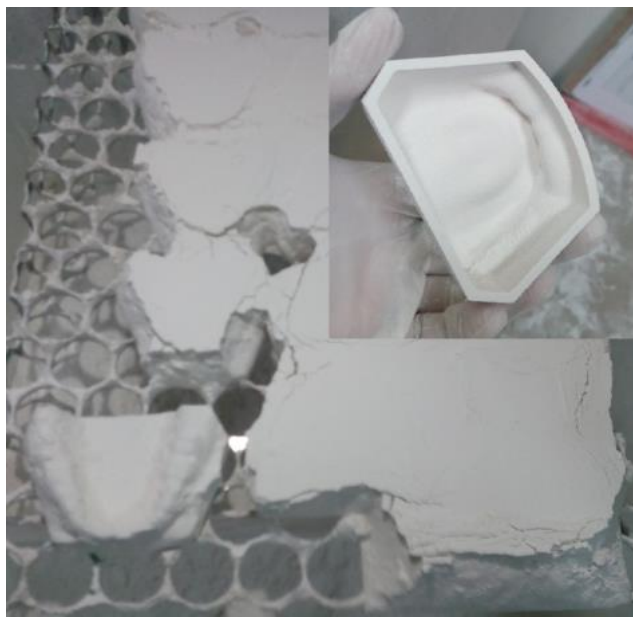
Figura 6 – Resultado da impressão com a placa de construção original.
