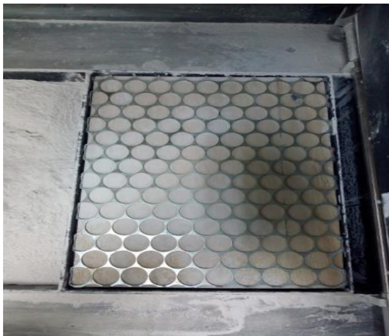
Figura 4 – Teste da nova placa de construção na impressora.
