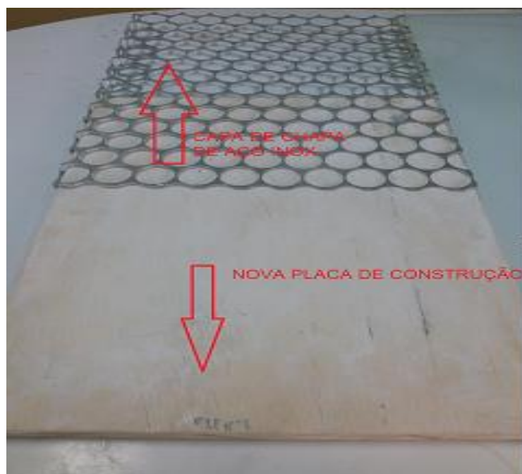
Figura 2 – Vista Frontal da nova Placa de construção com a capa de aço inox.
