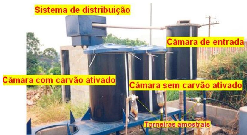
**Figura 1** – Sistema de Filtração lenta da FEAGRI/UNICAMP.
