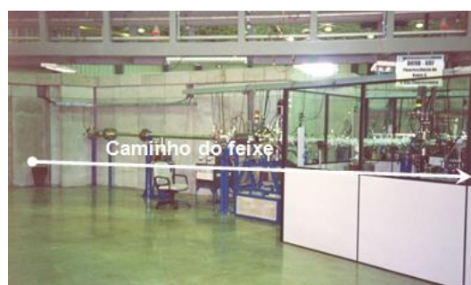
Figura 8 - Foto da tubulação do anel para a linha DO9B – XRF do Laboratório Nacional de Luz Síncrotron, por onde passa o feixe de luz síncrotron.
