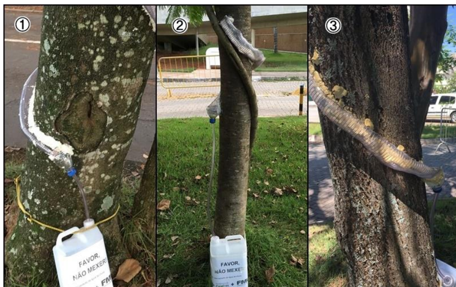
Figura 03 – Estruturas instaladas para captação do escoamento pelo tronco (ET).
