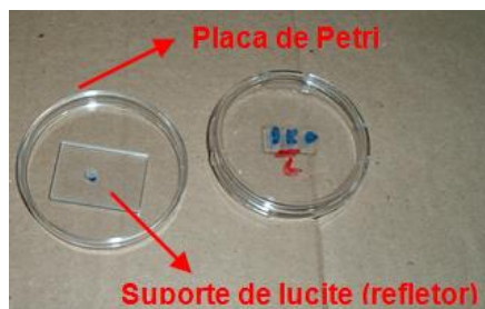
Figura 9: Suporte de lúcite utilizado para a deposição da amostra, acondicionado em Placas de Petri para armazenamento e transporte.
