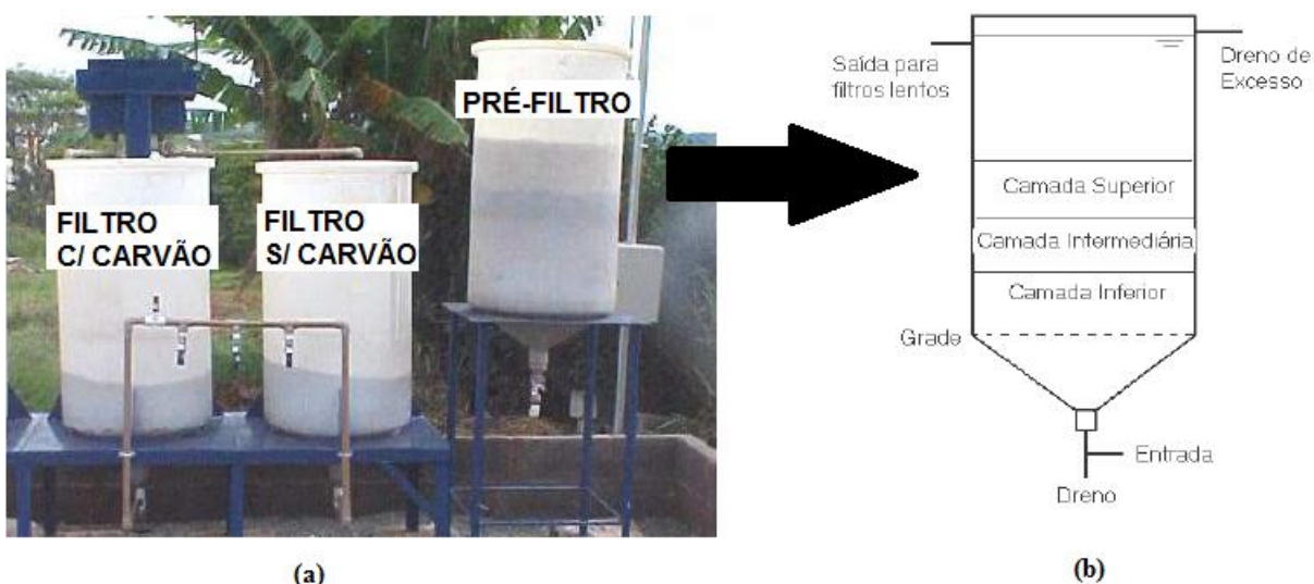
Figura 5: Vista do sistema antes da pintura (5a) e um esboço das separações de camadas internas.
