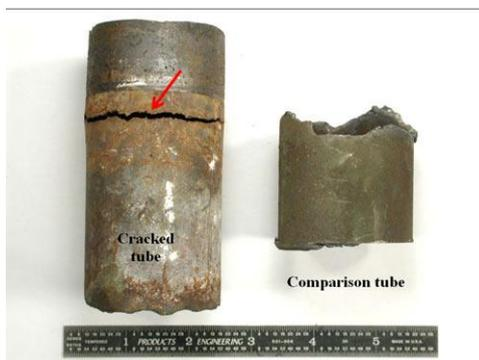
**Figura 5** – Corrosão por tensão
