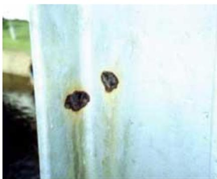
**Figura 6** – Corrosão por pontos
