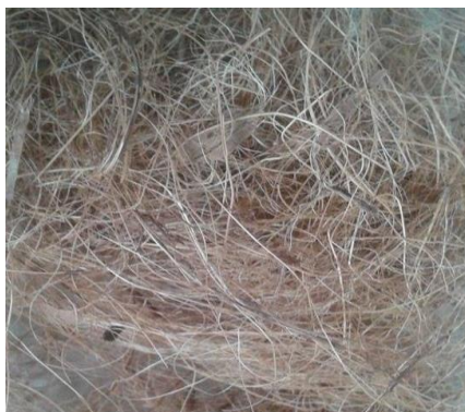
Figura 1. Aspecto das fibras de côco após secagem ao ar livre.
